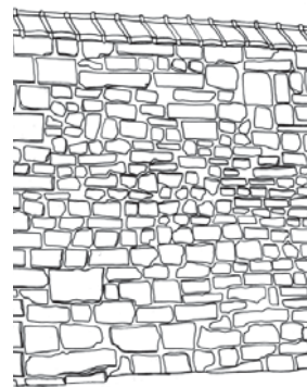
Mur en moellon, brique, silex couvronné par des pannes picardes
