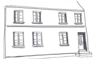
Les ouvertures de ces maisons sont ordonnancées : linteaux, appuis de fenêtre sont alignés sur 2 niveaux
