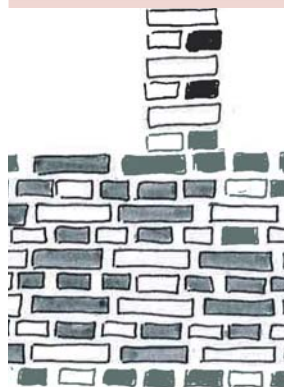
Appareillage panneresse boustisse d'un mur de brique argile et silico-calcaire
